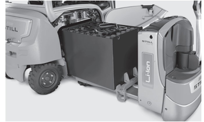
Elektrikli transpalet ile akü değişimi
