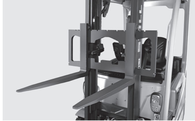
Yüksek ağırlıklı yükleri yüklerken çatal uçlarının optimum görünümü
