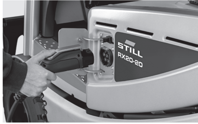
Akü değişimsiz merkezi olmayan yerlerde şarj yapılması için isteğe bağlı yerleşik şarj cihazı
