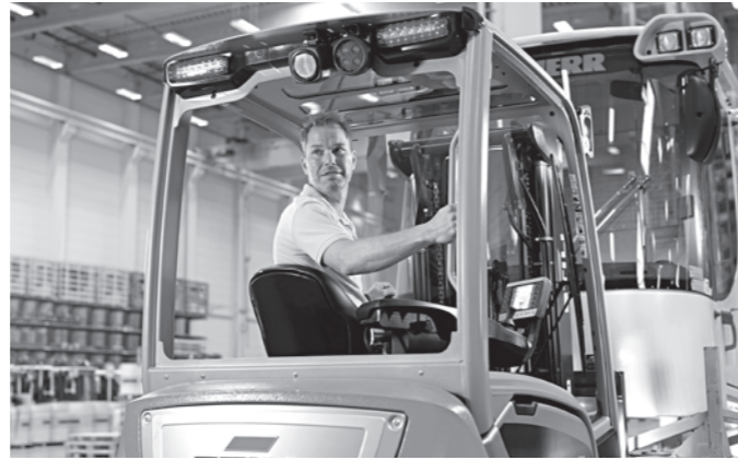
Geri sürüşler için isteğe bağlı kornalı tutacaklı dönel koltuk
